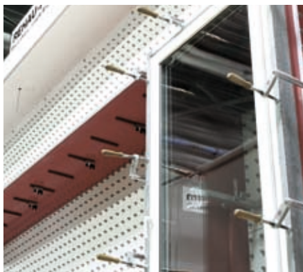
Vizsgáló berendezés szélnyomáshoz
