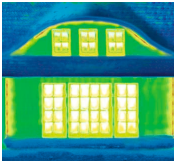
A felújítás után: minimális energiavesztés GENEEO® profilokból készült ablakokkal.
